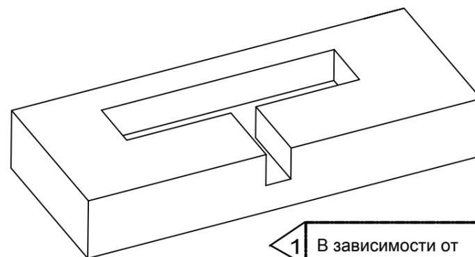
1 В зависимости от размера сифона и положения трубы, подходящие отверстия глубиной больше высоты сифона.
