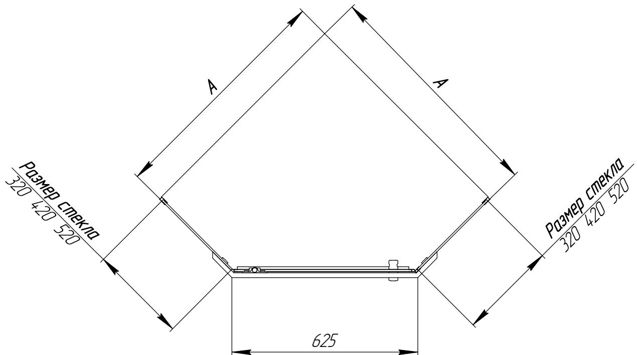
Регулировочный размер A - от угла до наружней кромки профиля изделия.
