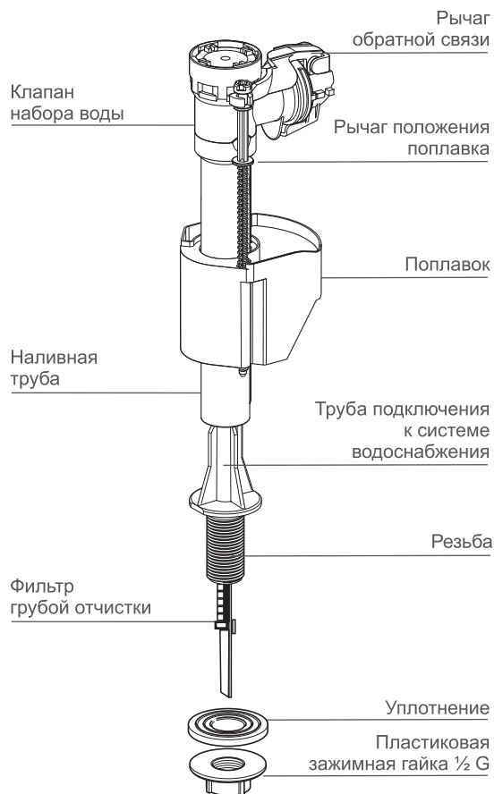
Рис. 5 Б1. Наливной механизм для унитазов «Сенатор», «Сенатор Люкс», «Сенатор Антисплеск»
